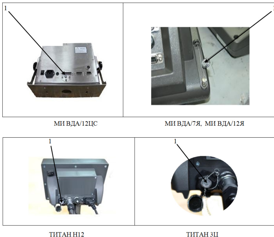
Рисунок 4 – Схема пломбировки терминалов от несанкционированного доступа, обозначение места нанесения пломбы, содержащей изображение знака поверки (1- место расположения пломбы с оттиском поверительного клейма)
