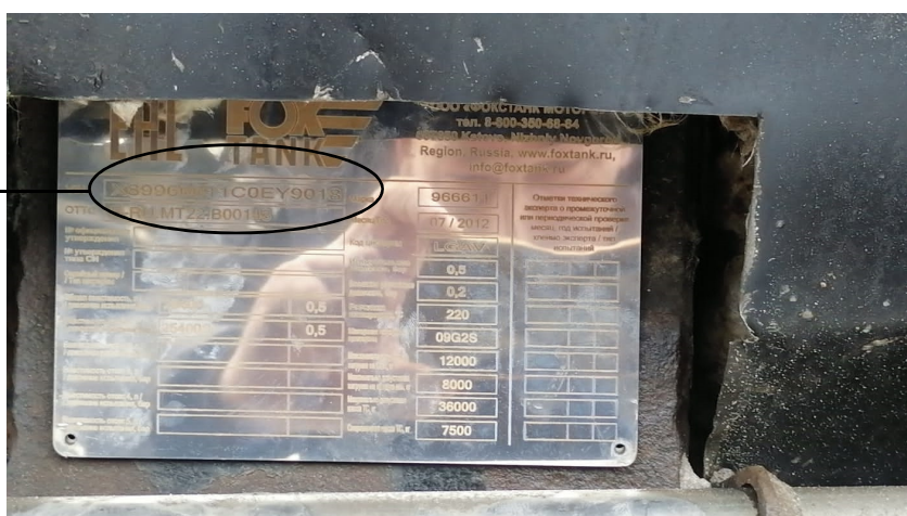
Рисунок 2 – Место нанесения заводского номера средства измерений
