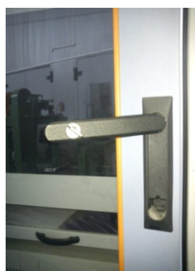
Рисунок 6 – Внешний вид замка на дверце стойки управления
