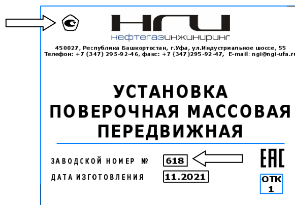
Рисунок 3 – Место нанесения знака утверждения типа и заводского номера на маркировочной табличке
