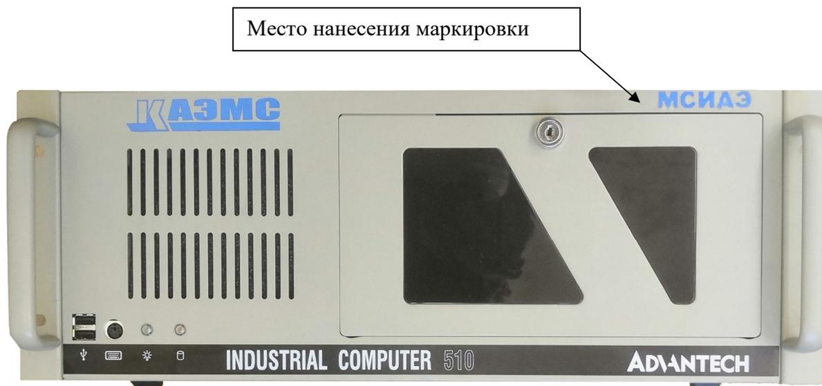
Рисунок 1 – Внешний вид модуля со стороны лицевой панели
