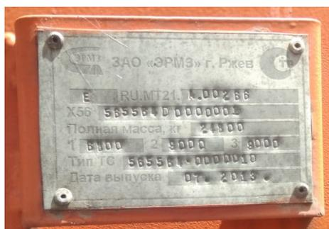
Рисунок 2 – Табличка с идентификационным номером автотопливозаправщика АТЗ-12-6312
