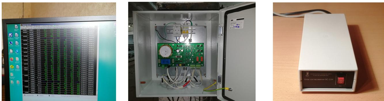
Рисунок 1 – Общий вид среднего уровня: контроллер БЦ-16 в герметичном корпусе и устанавливаемая внутри измерительная плата с установленными компонентами
