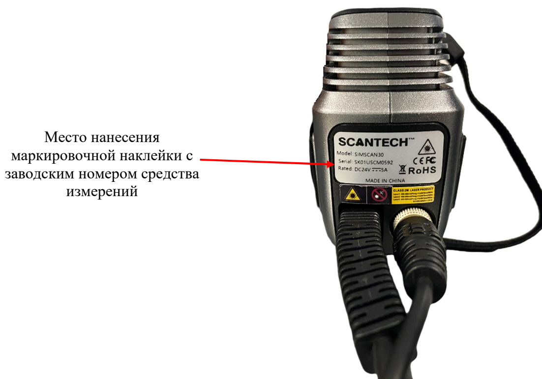
Рисунок 3 - Место расположения маркировочной наклейки с указанием заводского (серийного) номера прибора и место нанесения знака утверждения типа.
