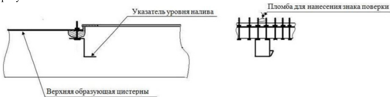
Рисунок 2 – Схема пломбировки от несанкционированного изменения положения указателя уровня налива в полости цистерны, обозначение места нанесения знака поверки
