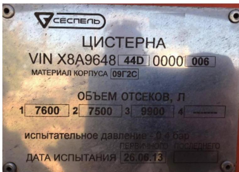
Рисунок 2 – Табличка с идентификационным номером полуприцеп-цистерны ППЦ 964844
