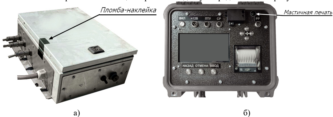
Рисунок 2 – Схема пломбирования от несанкционированного доступа а - модуль управления и вычисления с бортовой электроникой, б - блок управления и регистрации (БУР).
