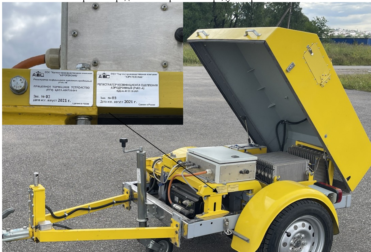
Рисунок 1- Общий вид регистратора коэффициента сцепления РеКС-А
