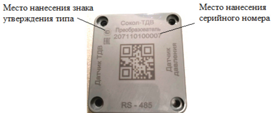
Рисунок 2 – Маркировочная крышка преобразователя измерителей Сокол-ТДВ с указанием мест нанесения знака утверждения типа и серийного номера
