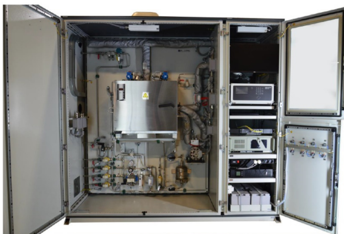
Рисунок 3 – Общий вид внутри шкафов системы MS3550-M2 (исполнение в виде шкафа)
