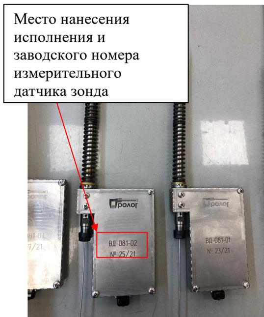
Место нанесения исполнения и заводского номера измерительного датчика зонда
