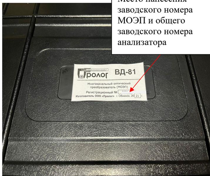
Место нанесения заводского номера МОЭП и общего заводского номера анализатора
