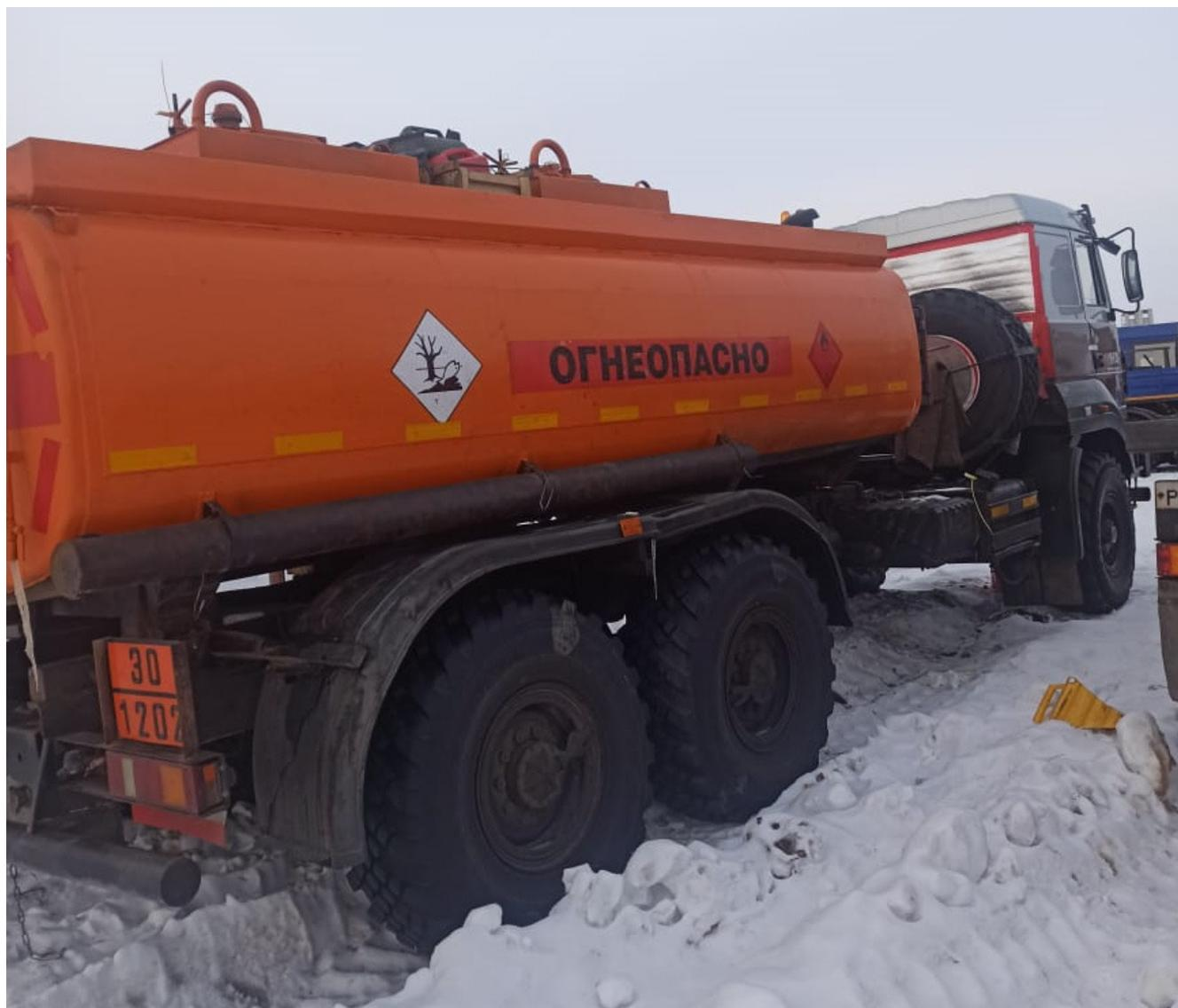
Рисунок 1 – Общий вид автотопливозаправщика АТЗ-12
