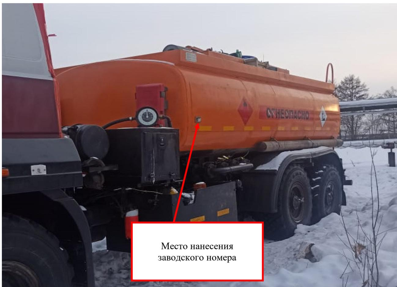
Рисунок 2 – Место нанесения заводского номера автотопливозаправщика АТЗ-12
