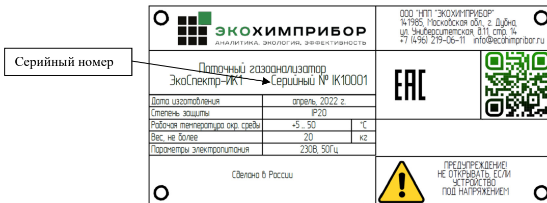
Рисунок 3 – Идентификационная табличка газоанализаторов
