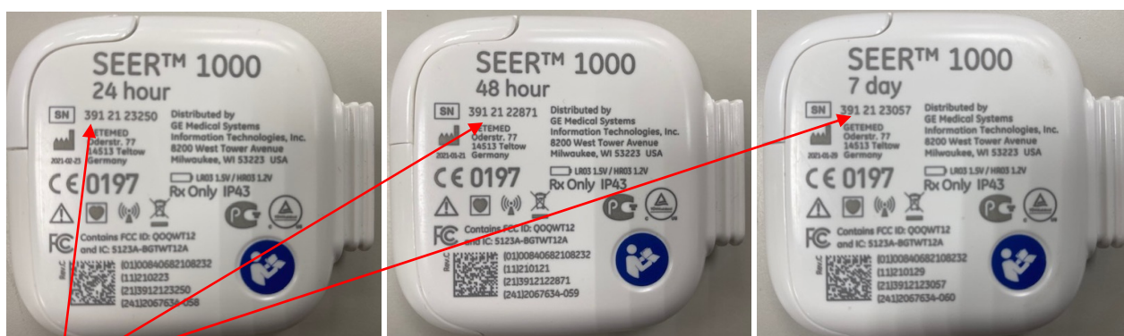
Рисунок 2 – Место нанесения заводского номера (А)
