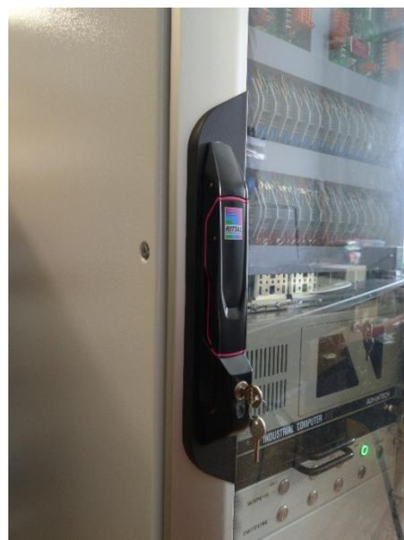
Рисунок 4 – Замок передней двери стойки АКПИ
