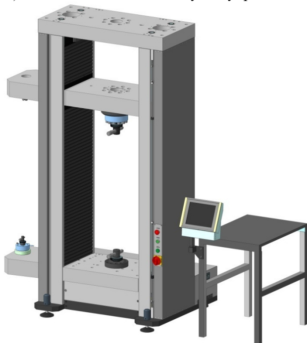
в) Машины с двумя рабочими зонами: основной и дополнительной консольного исполнения
