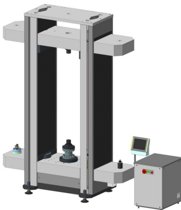
а) Машины с тремя рабочими зонами: основной и двумя дополнительными консольного исполнения, внешний модуль управления Рисунок 5 – Общий вид машин УТС-Р-У-Z
