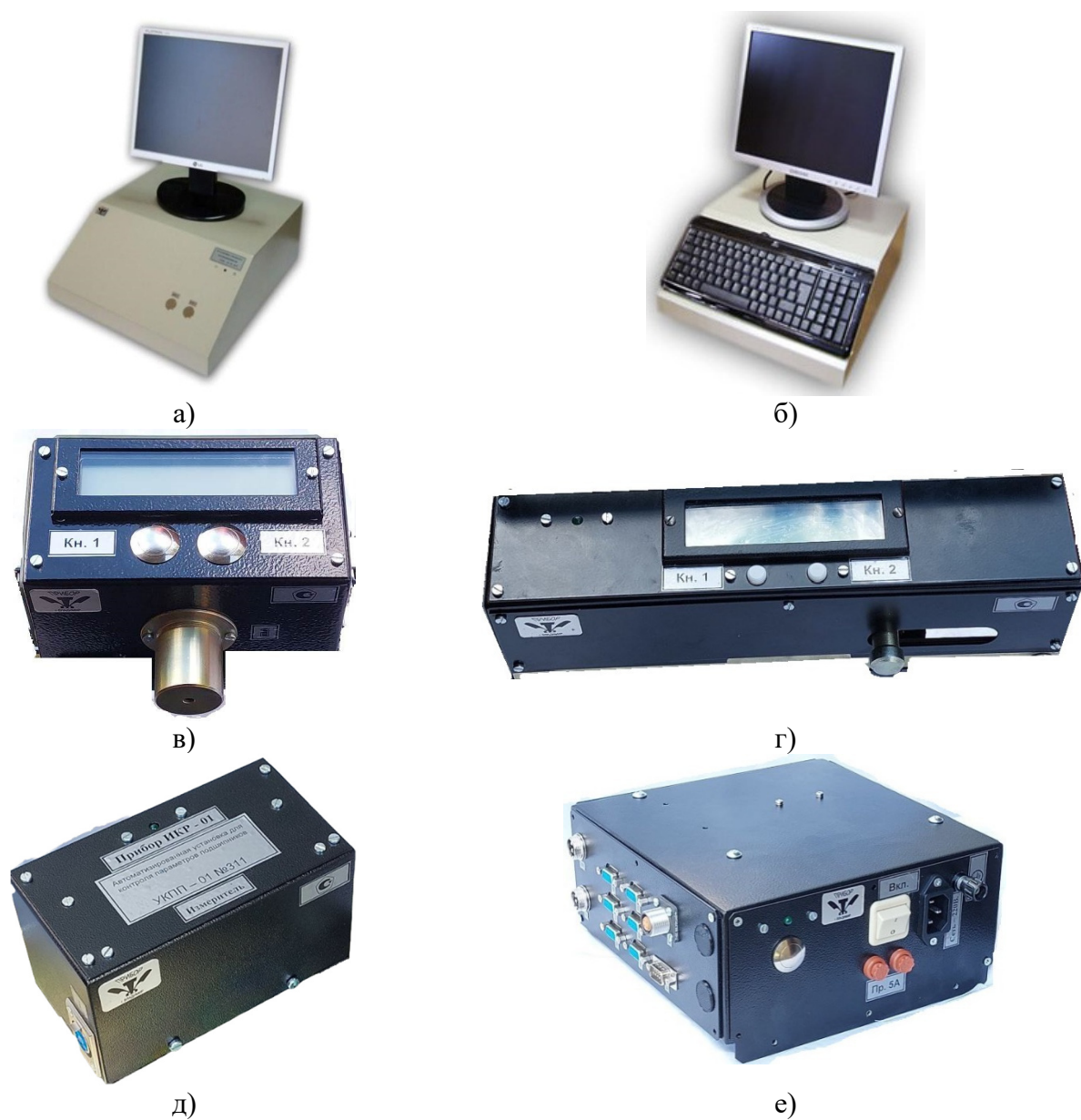
Рисунок 1 – Общий вид блоков измерительных: а) БИ-01 с органами управления в виде кнопок, исполнение 1; б) БИ-01 с органами управления в виде клавиатуры, исполнение 2; в) БИ-02 исполнение 1; г) БИ-02 исполнение 2; д) БИ-03 исполнение 1; е) БИ-03 исполнение 2
