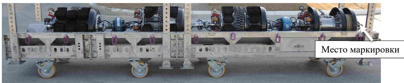
Рисунок 4 – Общий вид и места маркировки дефектоскопа 28-МСК.02-00.000
