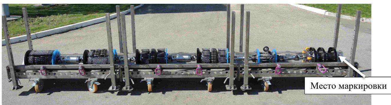
Рисунок 1 – Общий вид и места маркировки дефектоскопа 12-МСК.02-00.000
