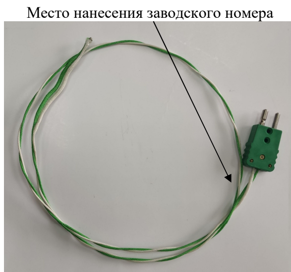
Рисунок 1 – Общий вид ТП с указанием места нанесения заводского номера
