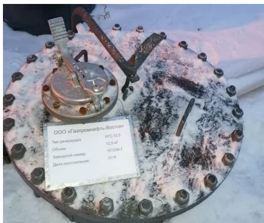
Рисунок 2 – Маркировочная табличка резервуара РГС-12,5
