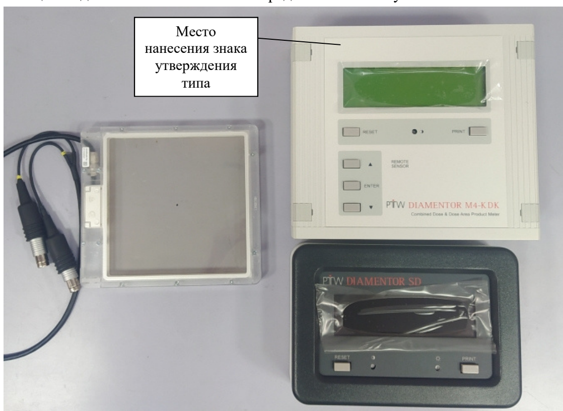
Рисунок 1 - Общий вид дозиметра рентгеновского излучения DIAMENTOR M4-KDK с указанием места нанесения знака утверждения типа (слева - ионизационная камера, справа сверху - цифровой дисплейный блок, справа снизу - дополнительный дисплейный блок)
