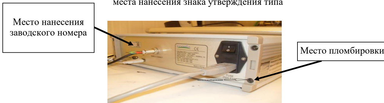
Рисунок 2 – Общий вид задней панели основного блока установки с указанием мест пломбировки и нанесения заводского номера
