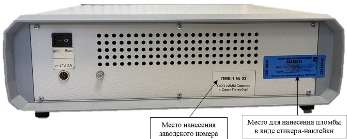
Рисунок 2 — Схема пломбировки от несанкционированного доступа и указание места нанесения заводского номера
