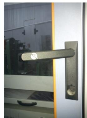
Рисунок 4 – Внешний вид замка на дверце стойки управления
