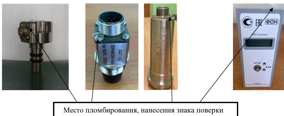
Рисунок 4 – Схема пломбировки от несанкционированного доступа, нанесения знака поверки.
