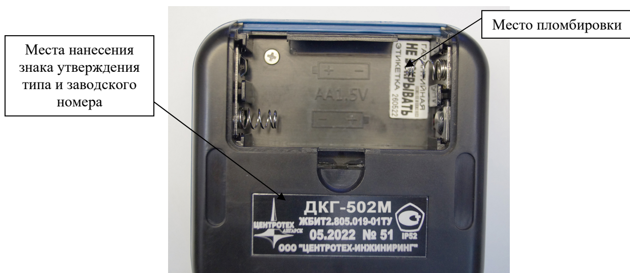
Рисунок 2 – Места нанесения знака утверждения типа, заводского номера и место пломбировки
