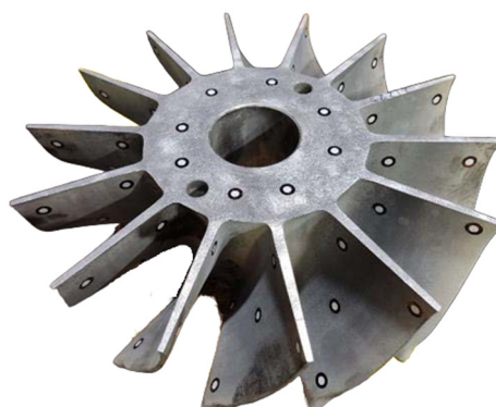
Рисунок 2 – Общий вид меток и пример их нанесения на объект сканирования
