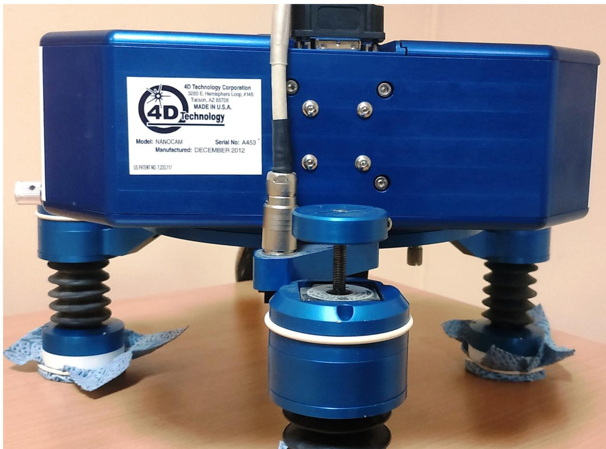
Рисунок 1 – Общий вид профилометра NanoCam Sq.
