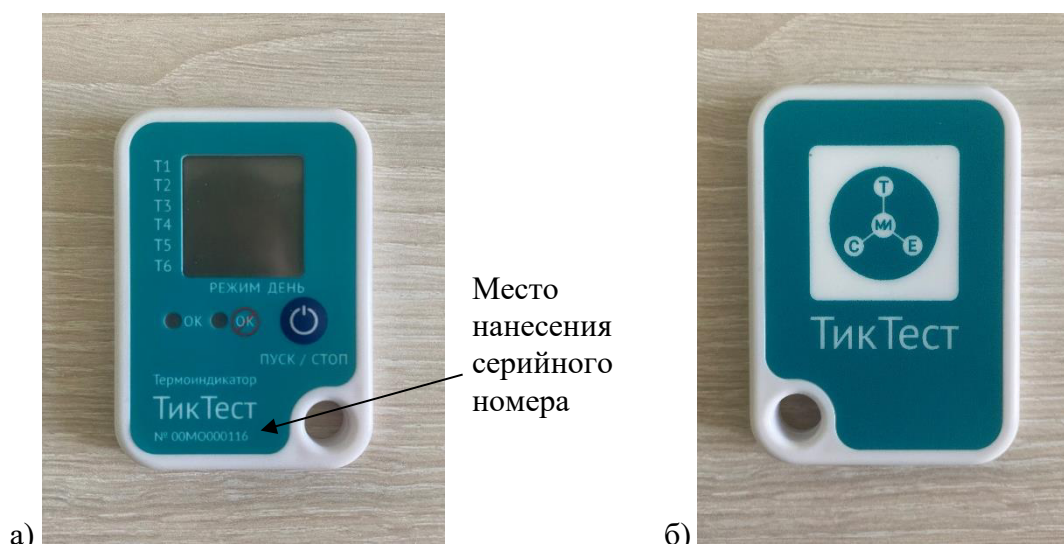
Рисунок 1 – Общий вид термоиндикаторов а) вид спереди; б) вид сзади
