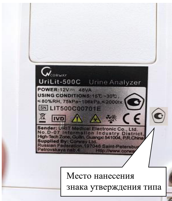
В - место нанесения знака утверждения типа для модели UriLit 500C
