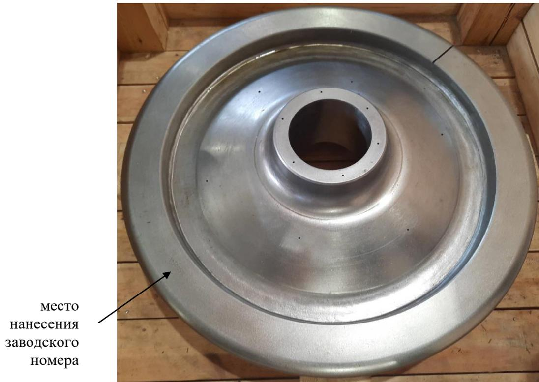
Рисунок 1 - Общий вид мер неразрушающего контроля ВМТ УЗК-КЛ-01
