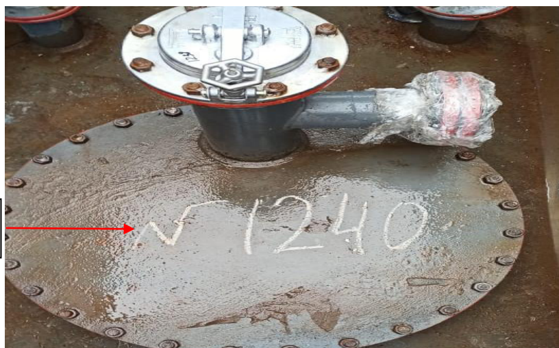
Рисунок 5 – Фотография горловины и заводского номера резервуара стального горизонтального цилиндрического РГС, модификации РГС-200 с зав. № 1240
