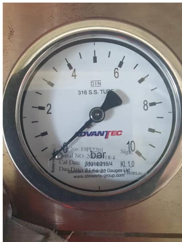
Рисунок 3 - Общий вид манометра показывающего STEWARTS
