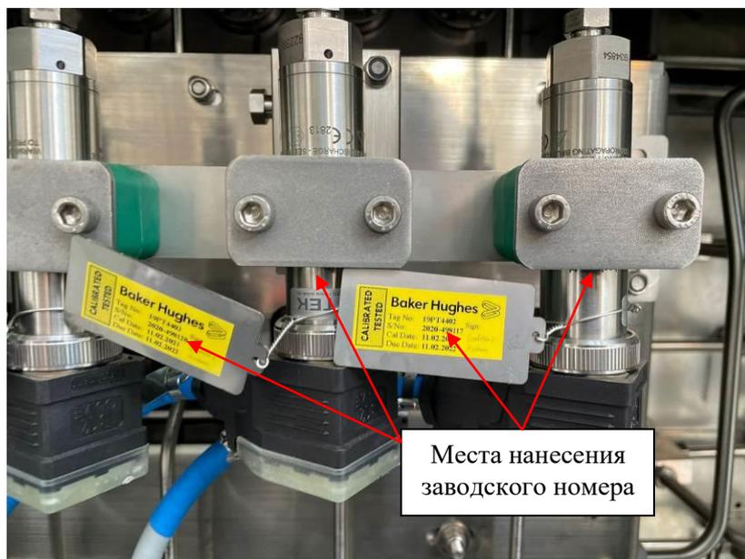
Рисунок 2 – Места нанесения заводского номера
