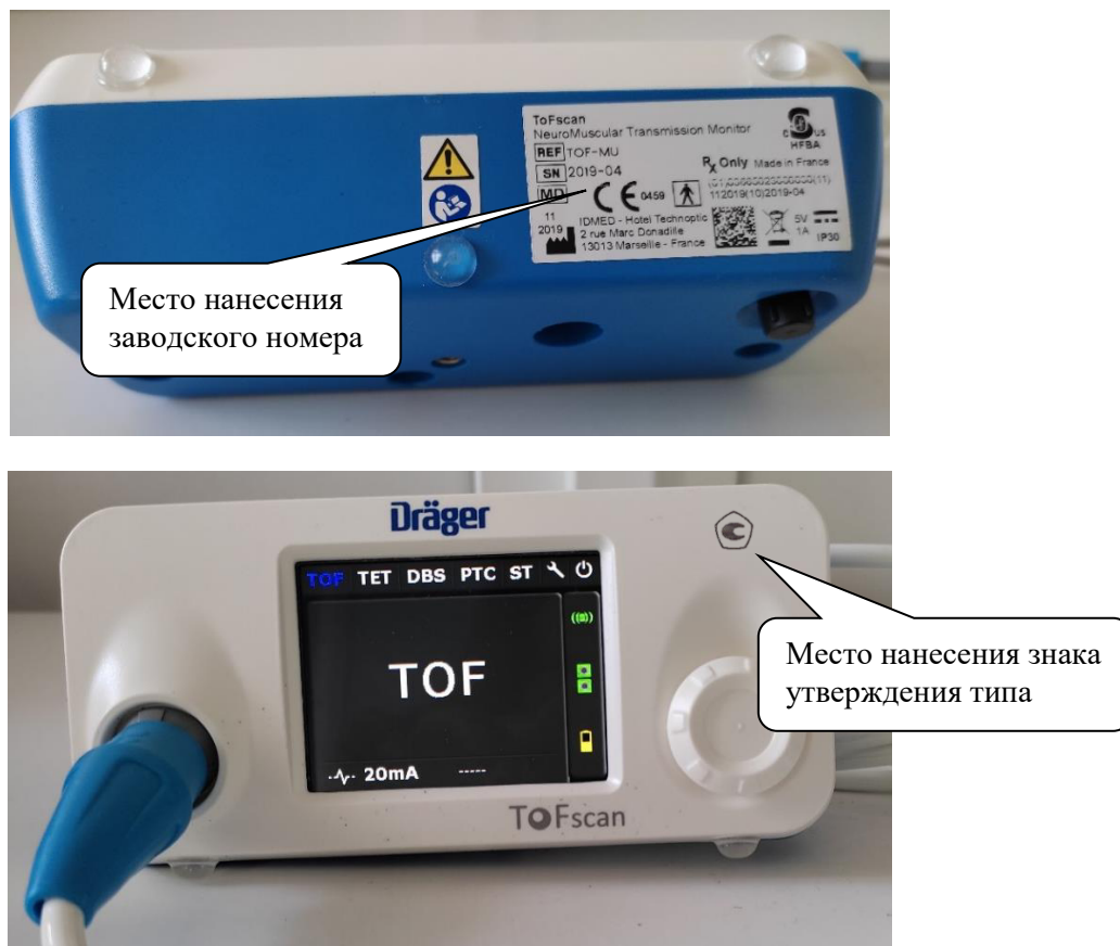
Рисунок 2 – Место, способ и формат нанесения заводских номеров или буквенно-цифровых обозначений, однозначно идентифицирующих каждый экземпляр средств измерений и знака утверждения типа
