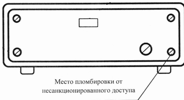
Рисунок 3.1 – Схема пломбировки от несанкционированного доступа
