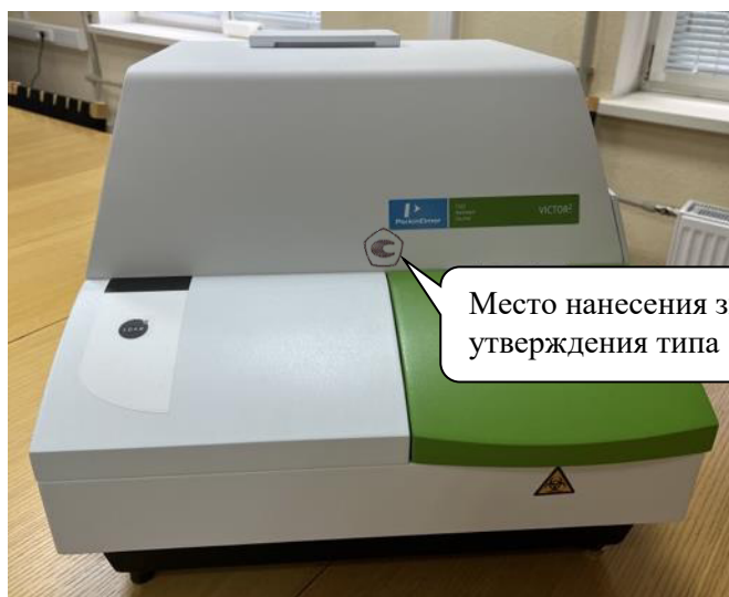
Рисунок 2 – Место, способ и формат нанесения заводских номеров или буквенно-цифровых обозначений, однозначно идентифицирующих каждый экземпляр средств измерений и знака утверждения типа
