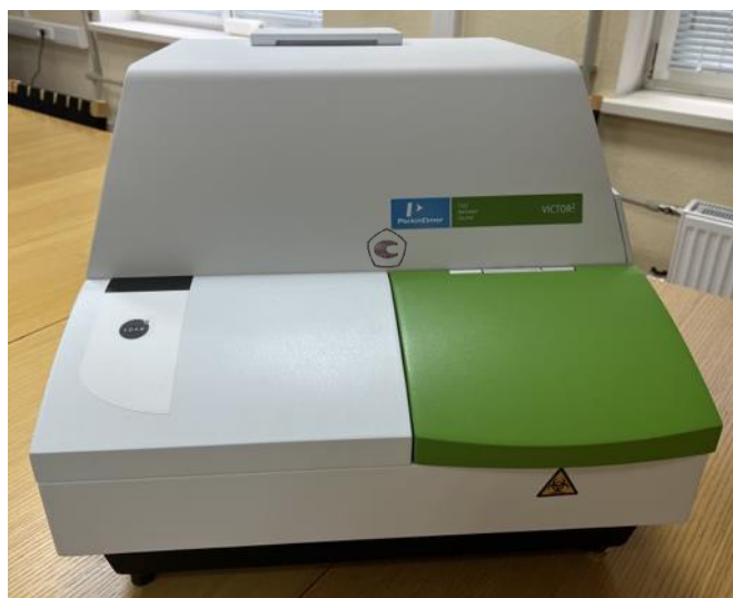
Рисунок 1 - Общий вид приборов-счетчиков лабораторных Wallac 1420 Multilabel Counter (Victor 2).
