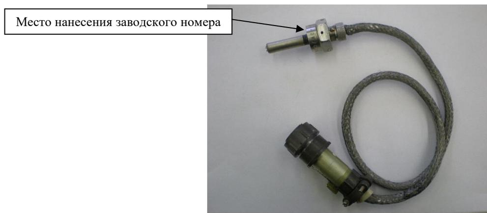
Рисунок 2 – Общий вид ТП и место нанесения заводского номера
