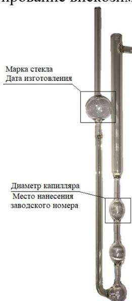
Рисунок 1 – Общий вид вискозиметров стеклянных капиллярных модификации ВНЖ
