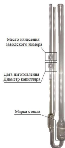
Рисунок 2 – Общий вид вискозиметров стеклянных капиллярных модификации ВПЖ исполнение ВПЖ-1
