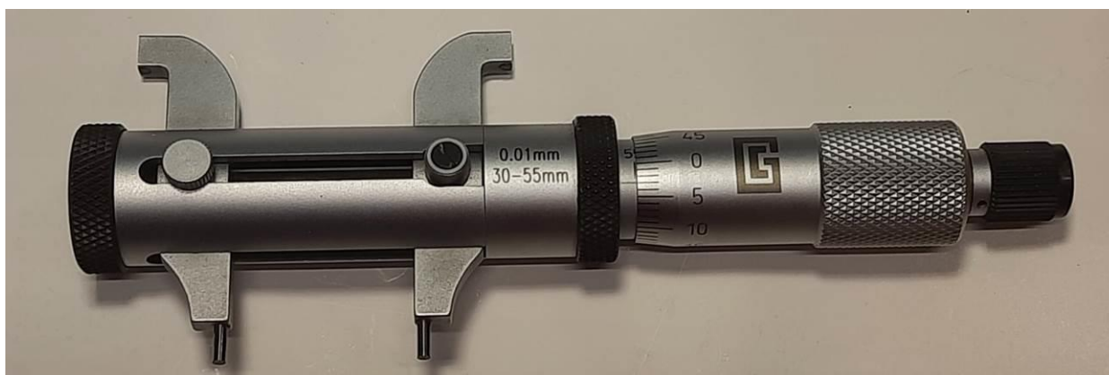
Рисунок 6 – Общий вид нутромеров модификации НМ-А6 двустороннего (сторона 2 с диапазоном измерений от 30 до 55 мм)
