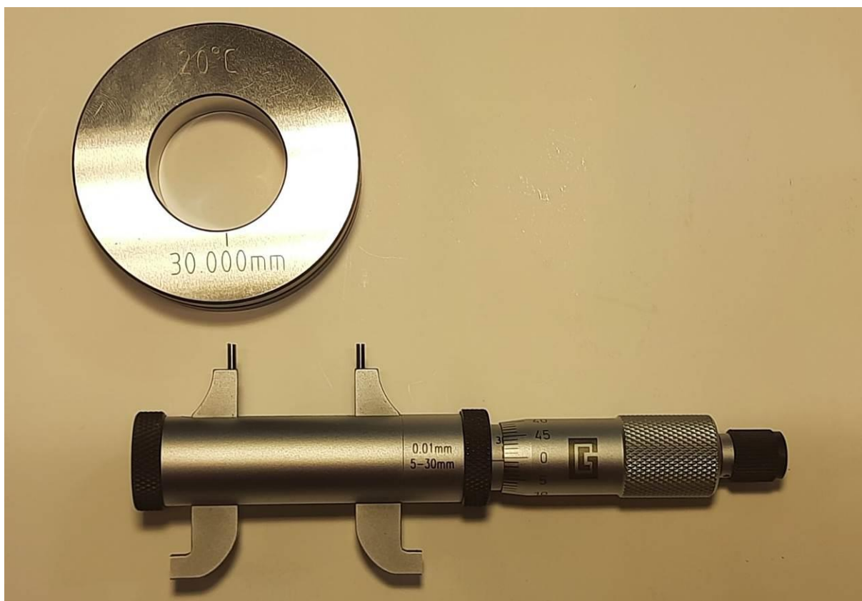
Рисунок 5 – Общий вид нутромеров модификации НМ-А6 двустороннего (сторона 1 с диапазоном измерений от 5 до 30 мм)
