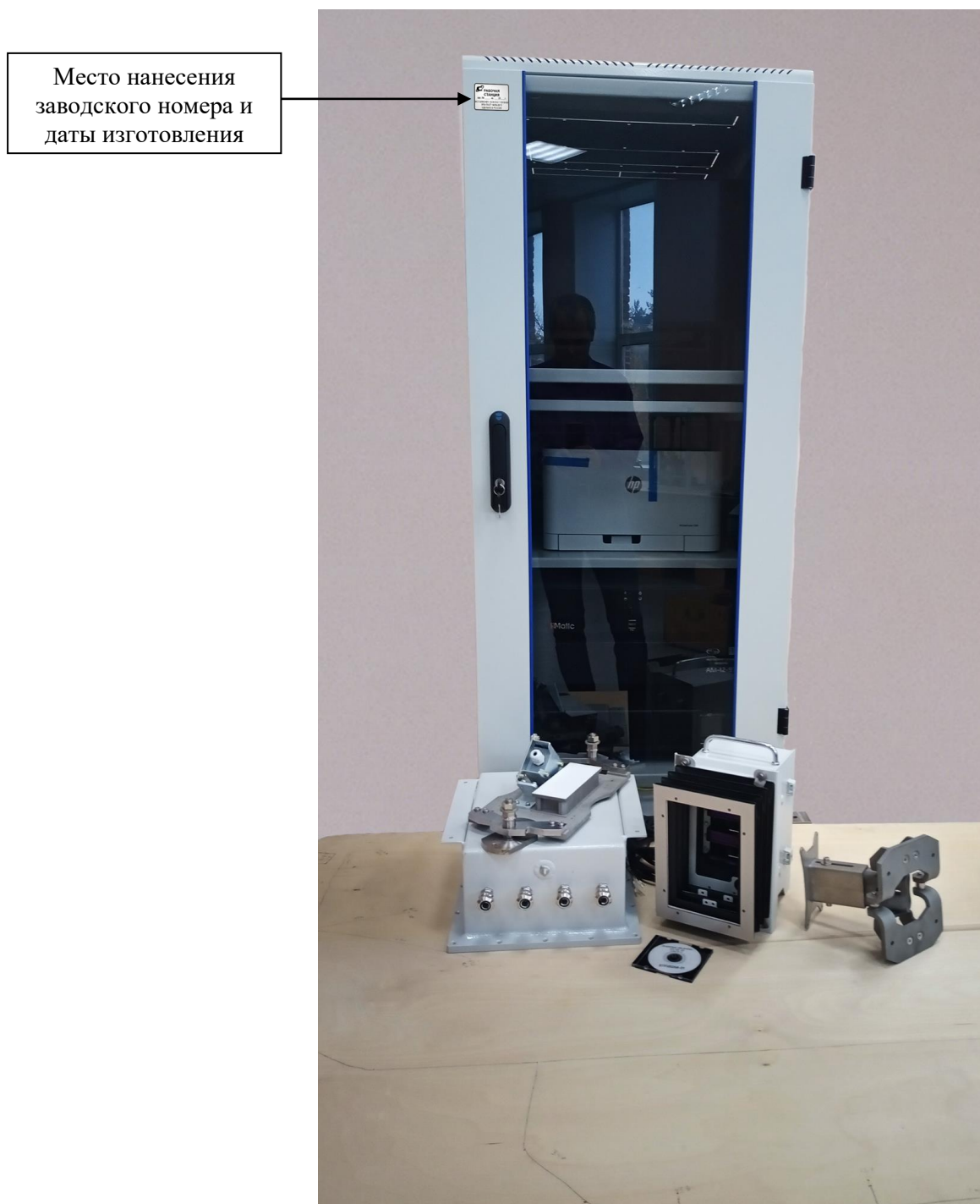
Рисунок 1 – Общий вид и маркировка АСК НДС ДП (шкаф)
