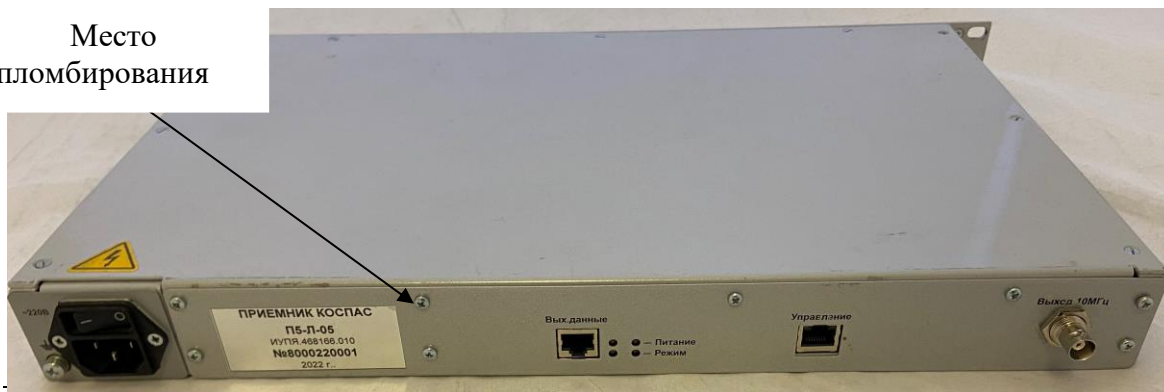
Рисунок 2 – Общий вид приемника КОСПАС П5-Л-05 (вид сзади)
