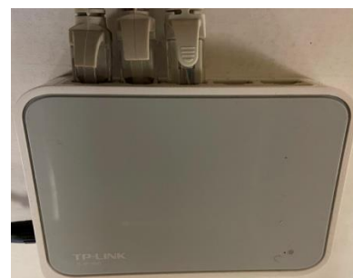
Рисунок 9 – Общий вид коммутатора TP LINK модель TL-SF1005D (5xEthernet 100 Мбит/с)
