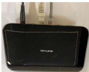
Рисунок 8 – Общий вид коммутатора TP LINK модель TL-SG1005D (5xEthernet1 Гбит/с)
