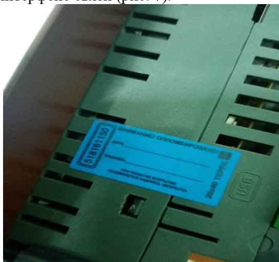
Рис. 7 – Пломбировочная наклейка на интерфейс связи
