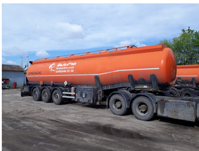
Рисунок 2 – Полуприцеп-цистерна для жидких нефтепродуктов GUTE WOLF DMD заводской номер NP9DMD012DA259078. Вид с бока.
