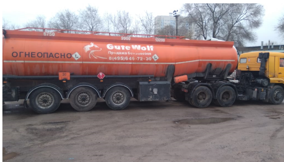
Рисунок 4 – Полуприцеп-цистерна для жидких нефтепродуктов GUTE WOLF DMD заводской номер NP9DMD012DA259077. Вид с бока.
