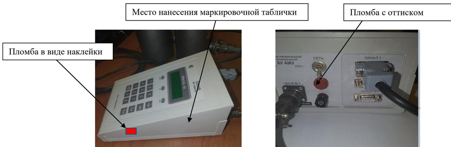
Рисунок 2 – Схема пломбировки средства измерений
