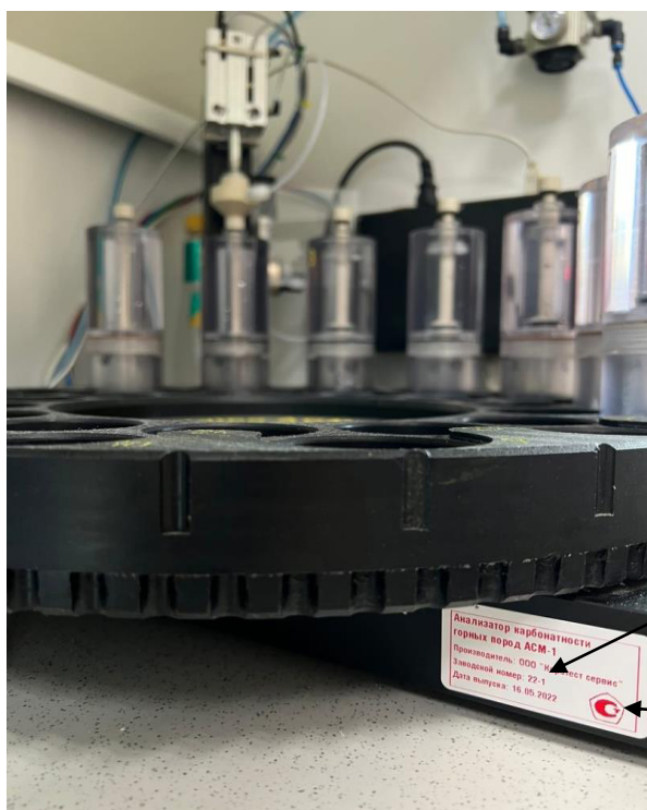
Рисунок 2 - Места нанесения заводского номера и знака утверждения типа на анализаторы карбонатности горных пород АСМ-1
