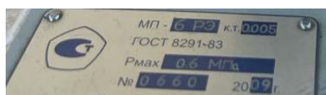
Рисунок 2 – Информационная табличка манометра грузопоршневого МП-6
